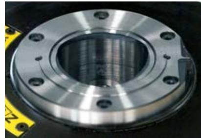
automatische Klemmung integraler Spindel für CAPTO® Werkzeuge\*
